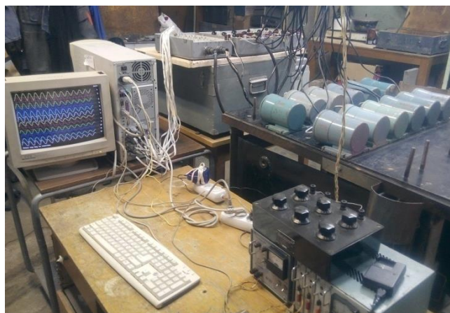
Рисунок 6. - Калибровка измерительных каналов ИССН с сейсмометрами на экспериментальном вибростенде.
